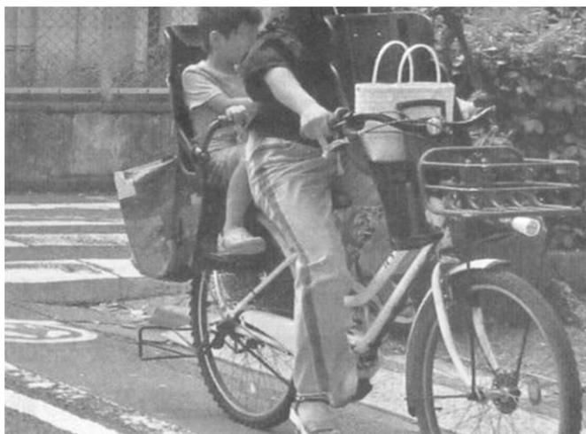
写真7 幼児の体重と荷物の重量で倒れ込み・前輪が浮く危険
